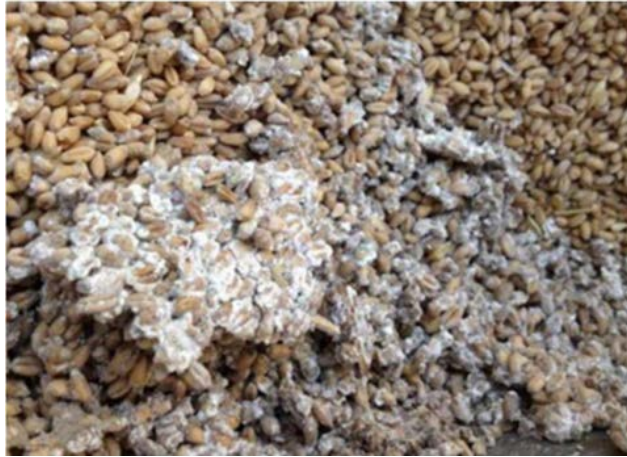
图 6 第 60 天在位置 B（距仓底 0.8 m，距冷壁 0.4 m）发现的变质（发霉）谷物
